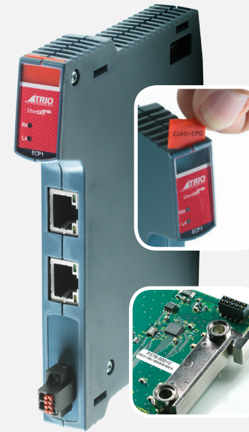
System Flexslice zaczyna się od adaptera sieciowego EtherCAT
