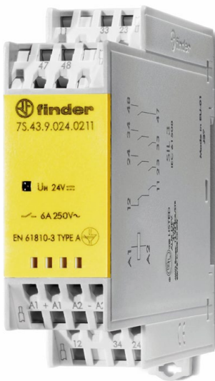
Rys. 3. Typ 7S.43/63 – 2 Z zestyki bezpieczeństwa – 1 R zestyk sygnału zwrotnego – 1 zestyk pomocniczy sygnalizacyjny
